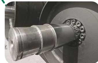
Presskammerwalzen mit durchgehender Welle
