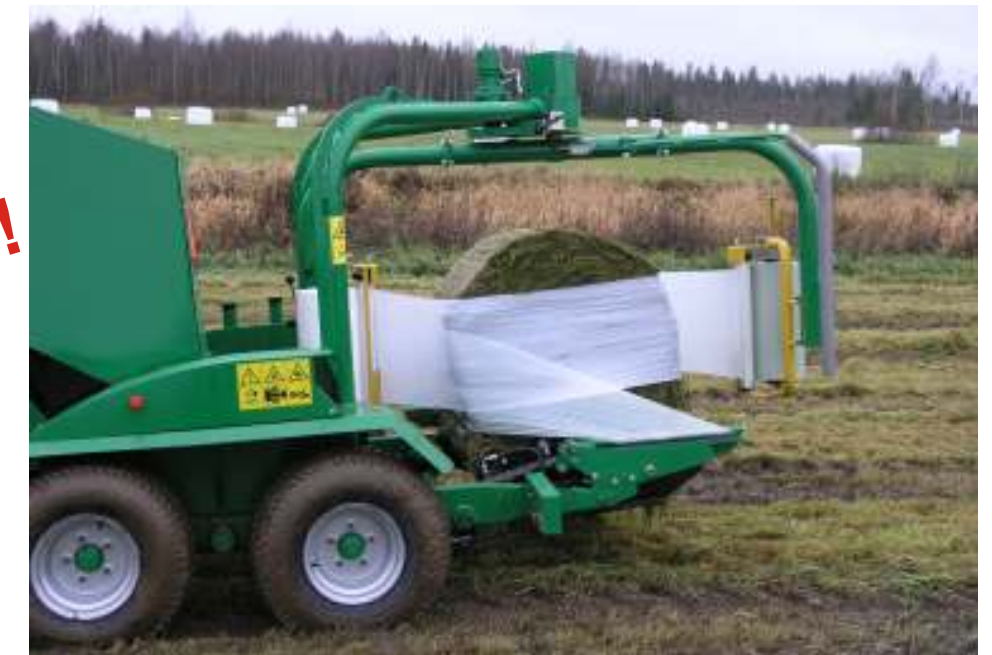
Doppelsatelliten-Wickler mit Schnellanpassung der Wickelhöhe.
