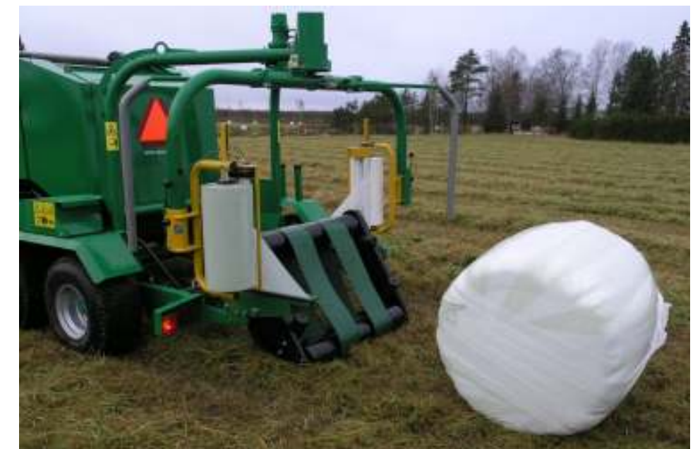
Doppelsatelliten-Wickler mit Schnellanpassung der Wickelhöhe.
